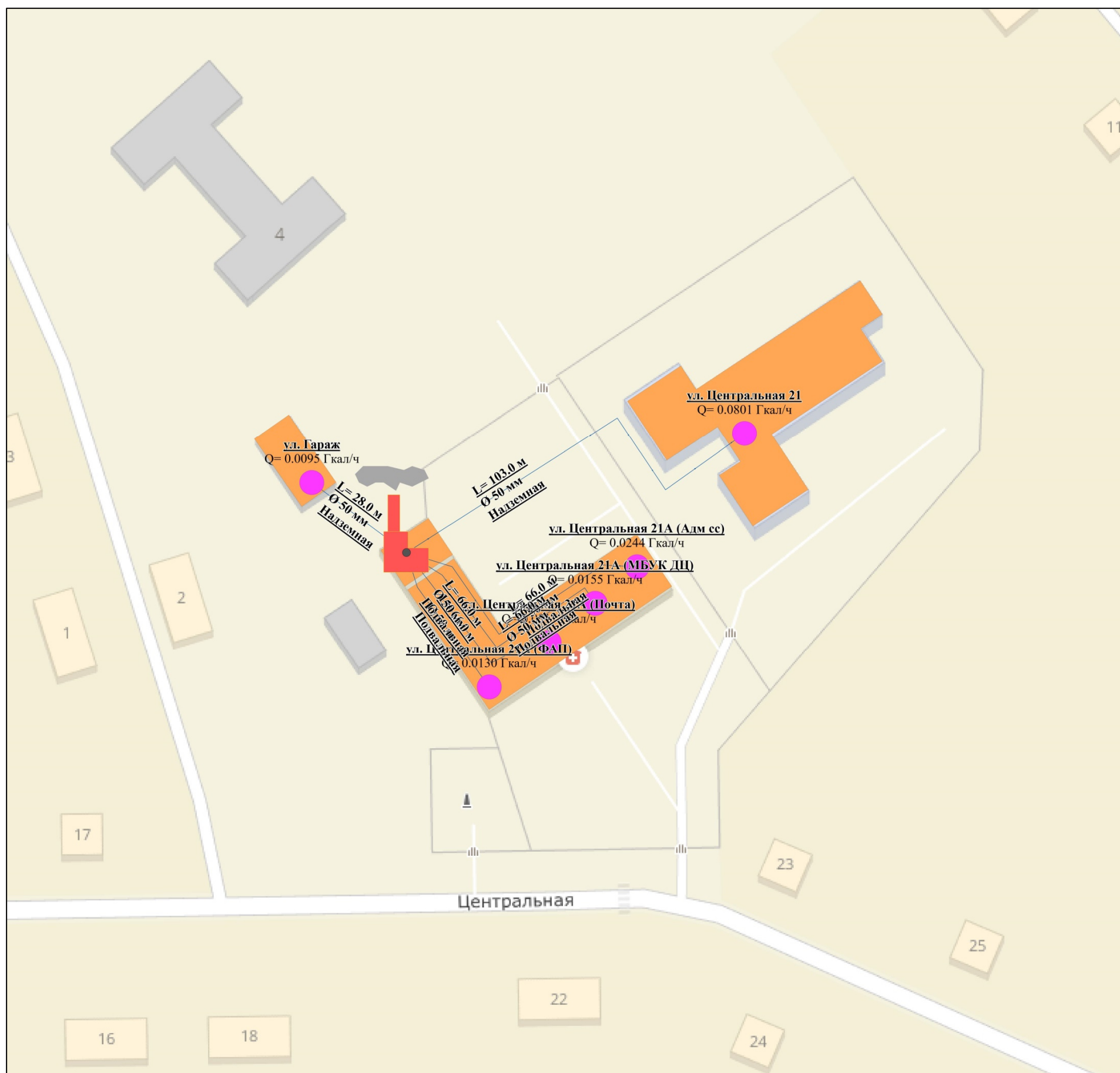
Рисунок 6 Схема тепловых сетей котельной с. Усть-Чём
