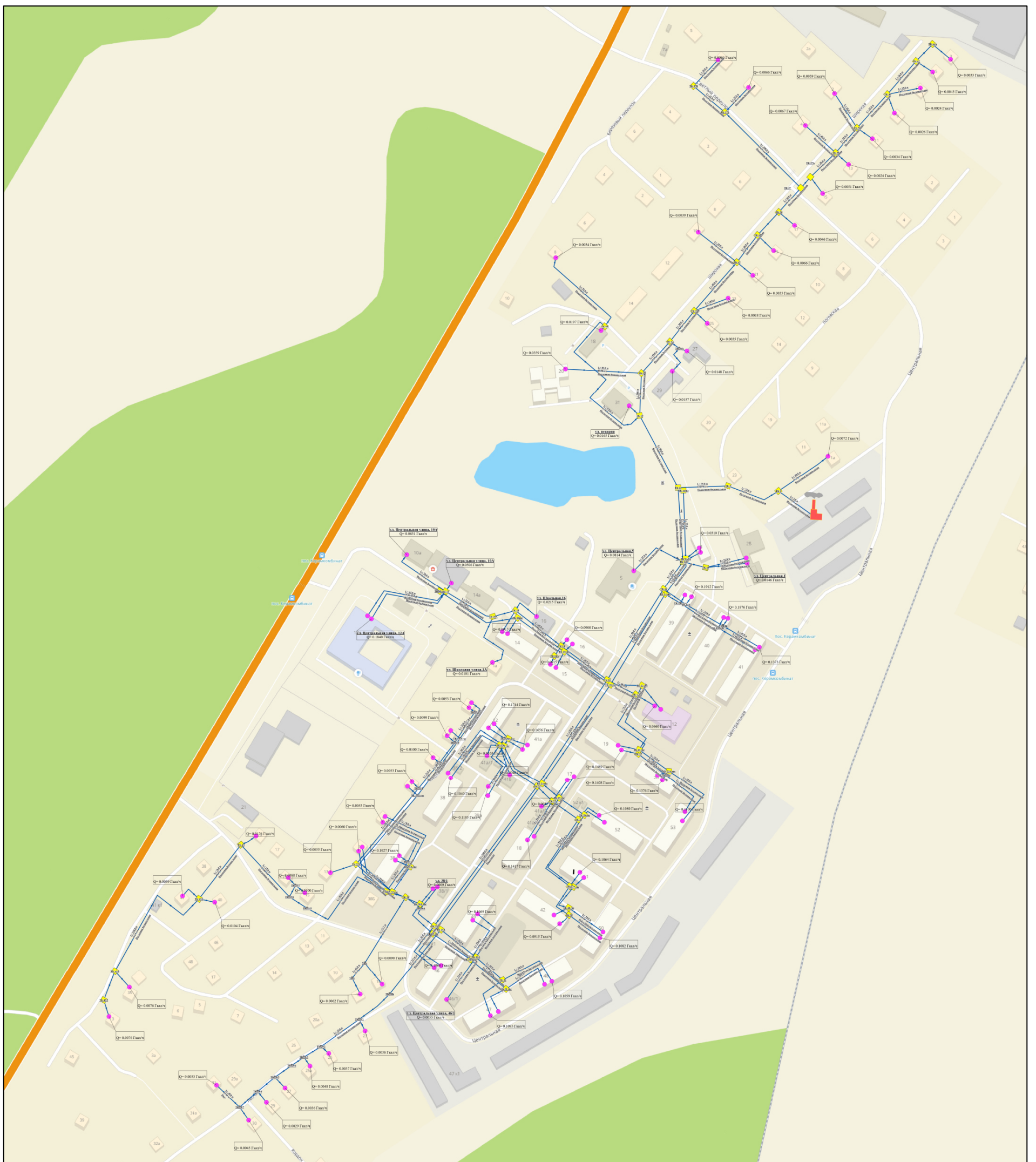
Рисунок 0.1 Схема тепловых сетей от котельной п. Керкомбинат.
