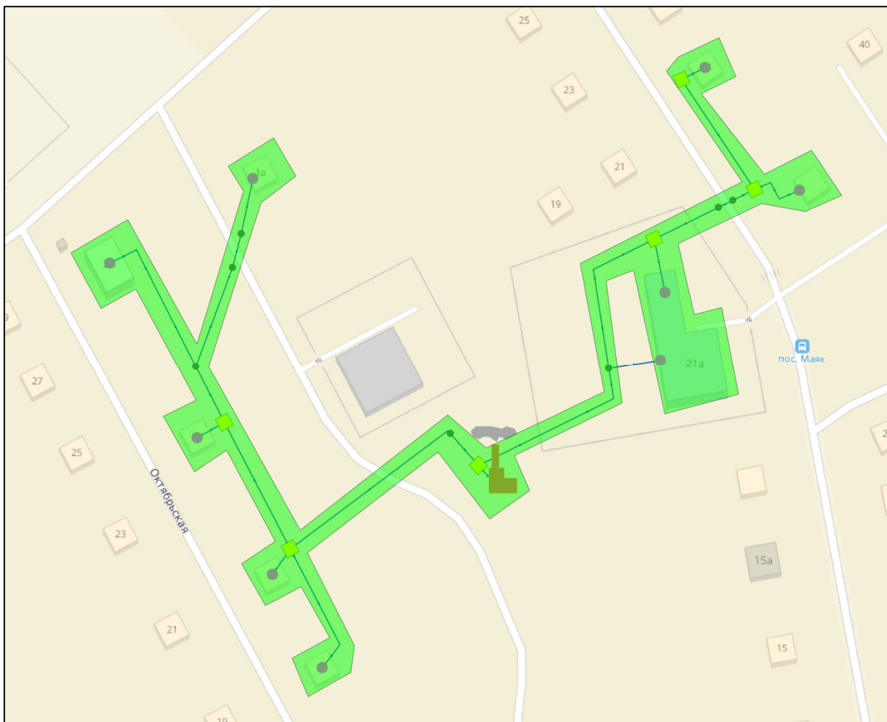
Рисунок 1.8 Схема тепловых сетей п. Маяк
