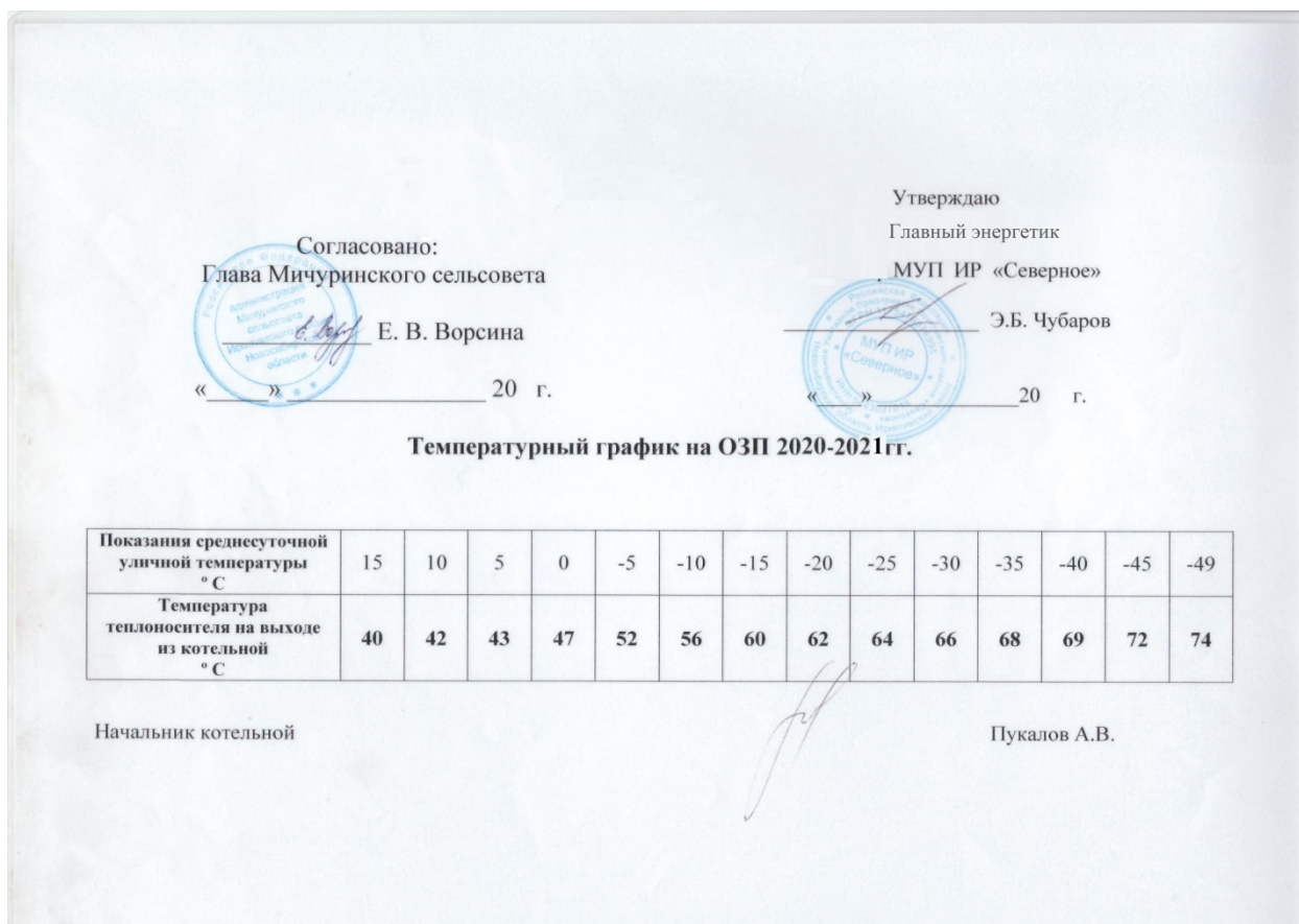
Рисунок 1.1 Температурный график отпуска тепловой энергии от котельной п. Агролес
