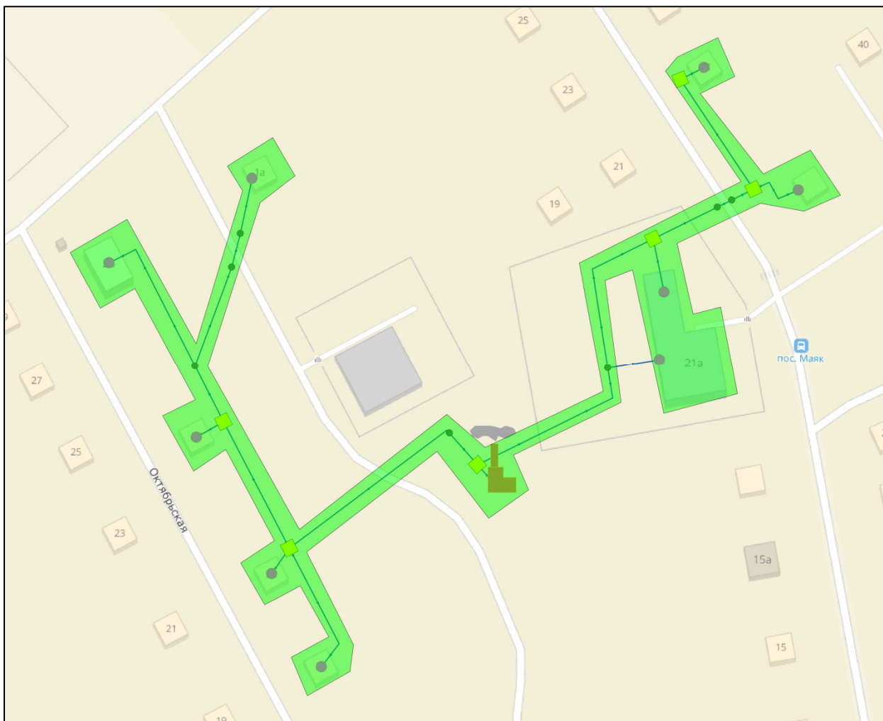
Рисунок 8. Схема тепловых сетей п. Маяк
