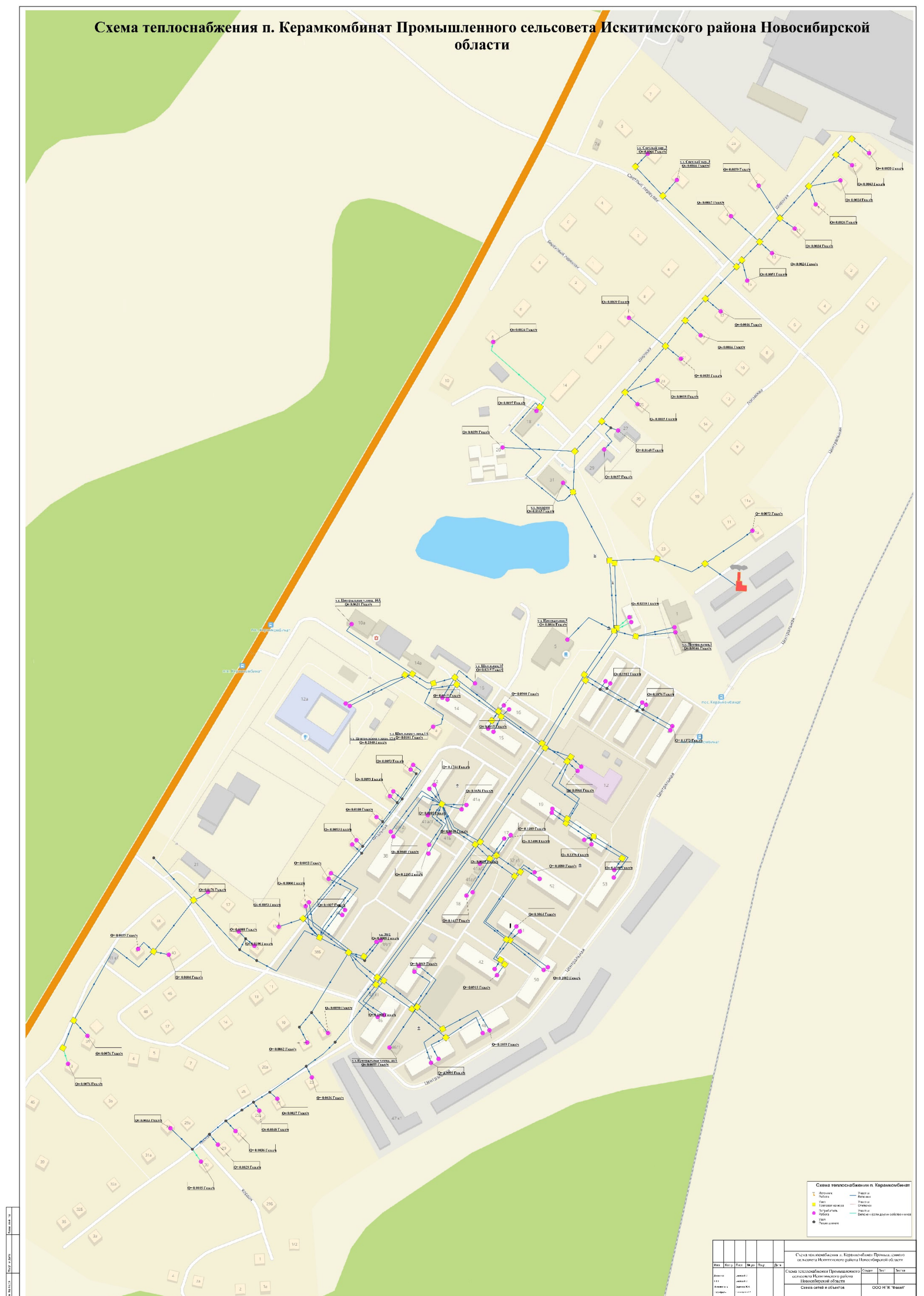
Рисунок 9. Схема тепловых сетей от котельной п. Керамкомбинат.
