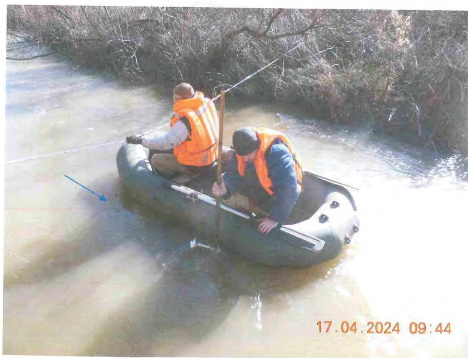
Рисунок 12 – Определение скорости потока вертушкой № 1649 измерительного комплекса
