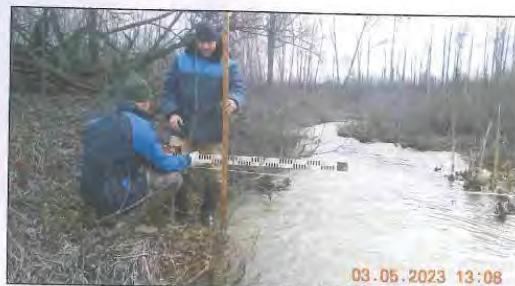
Рисунок 18 – Измерение уровня воды по свае № 5. Вид гидрологического поста «Заказчика»
