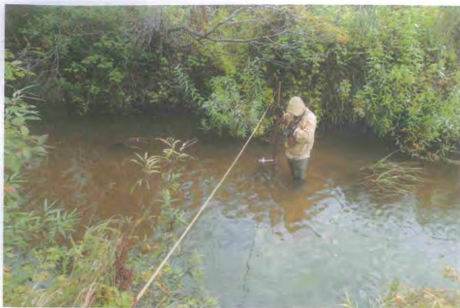
Рисунок 12 – Измерение скорости потока на скоростной вертикале вертушкой № 1649 измерительного комплекса ИСВП-ГР-21М1
