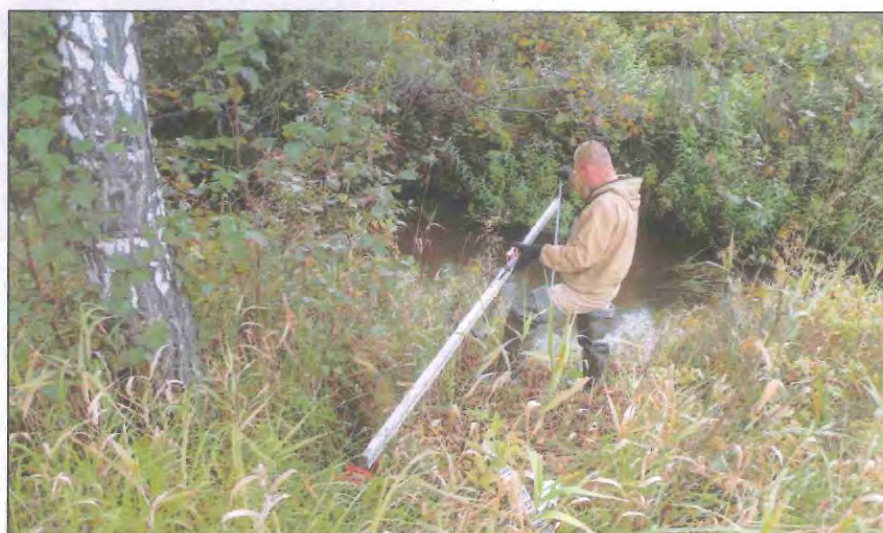
Рисунок 11 – Определение уровня воды в реке по свае поста
