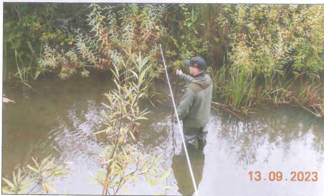
Рисунок 13 – Измерение скорости на верхнем створе р. Выдриха
