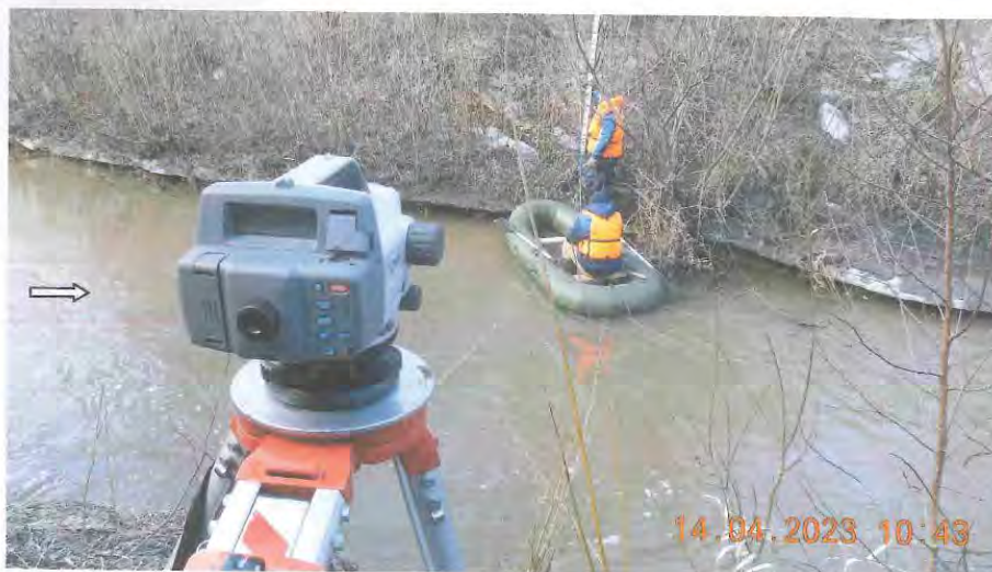
Рисунок 13 – Подготовка к измерению уровня воды на реке Выдриха
