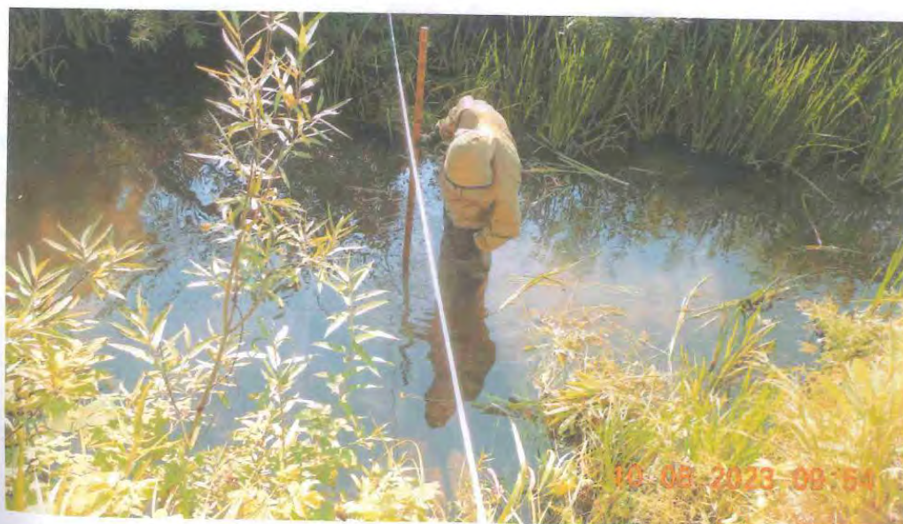
Рисунок 19 – Промер глубин р. Выдриха в створе «Заказчика»
