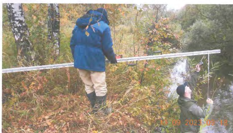
Рисунок 12 – Определение уровня воды в реке по свае поста
