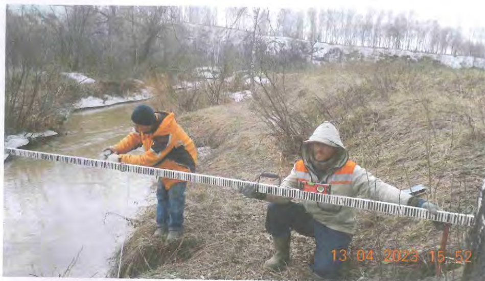
Рисунок 15 – Определение уровня воды в реке по свае поста
