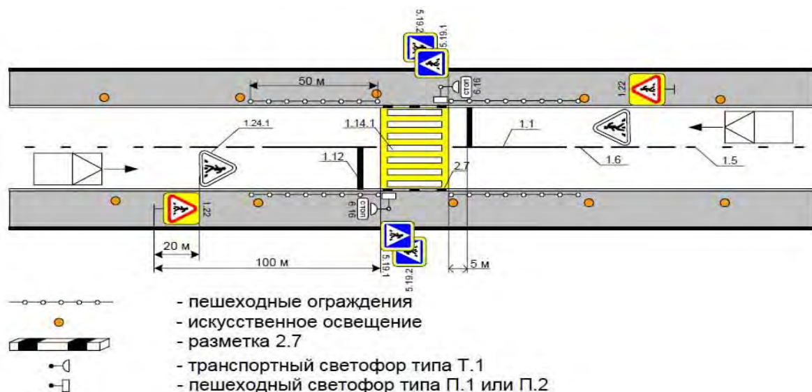
Рисунок 3.5.2 – Рекомендуемое оборудование пешеходного перехода
